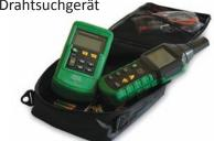
Geprüft werden können Kabel & Leitungen in Wand, Boden, Erde usw. Die Reichweite beträgt bis zu zwei Meter, die Sensibilität ist einstellbar. Das Gerät ist ein Set aus Sender und Empfänger. Zum Betrieb beider Geräte benötigt man 1 x 9 V Block Batterie sowie 6 x 1,5 V Batterie Form AAA. Weitere Informationen www.rumsauer.eu. Video unter www.youtube.com/ VORTbroadcast
