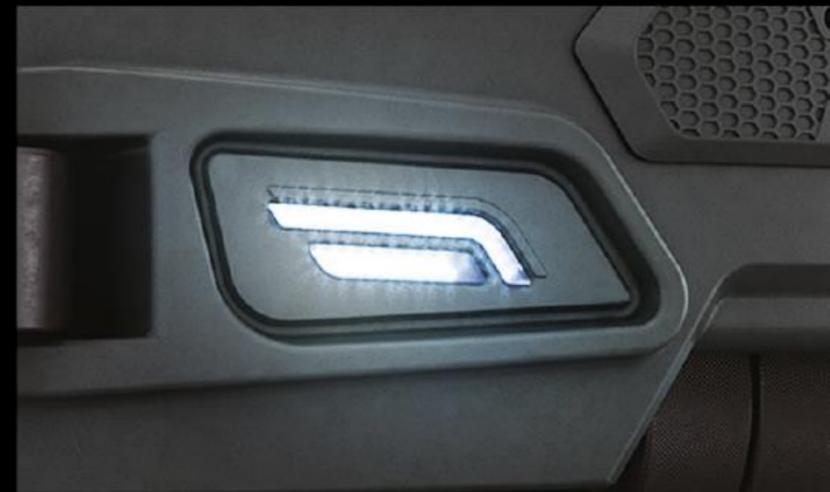
Das exklusive Servicebeleuchtungspaket verbessert die Sicht auf jene Teile, die vom Bediener kontrolliert werden müssten, indem die betroffenen Teile mit LED-Leuchten ausgeleuchtet werden
