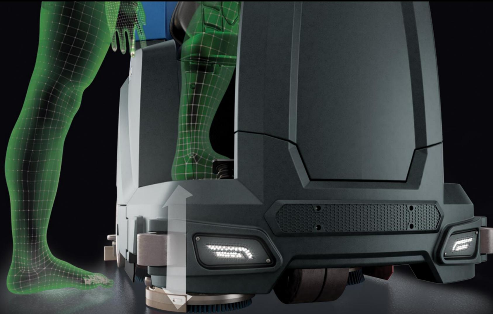
**Das tiefergelegene Trittbrett ermöglicht den mühelosen Zugang zum Fahrersitz von beiden Seiten**
