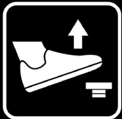
**Sowohl beim Aufwärtsfahren als auch beim Abwärtsfahren kommt die Maschine beim Loslassen des Pedals dank des Antriebskontrollsystems zum Stillstand**
