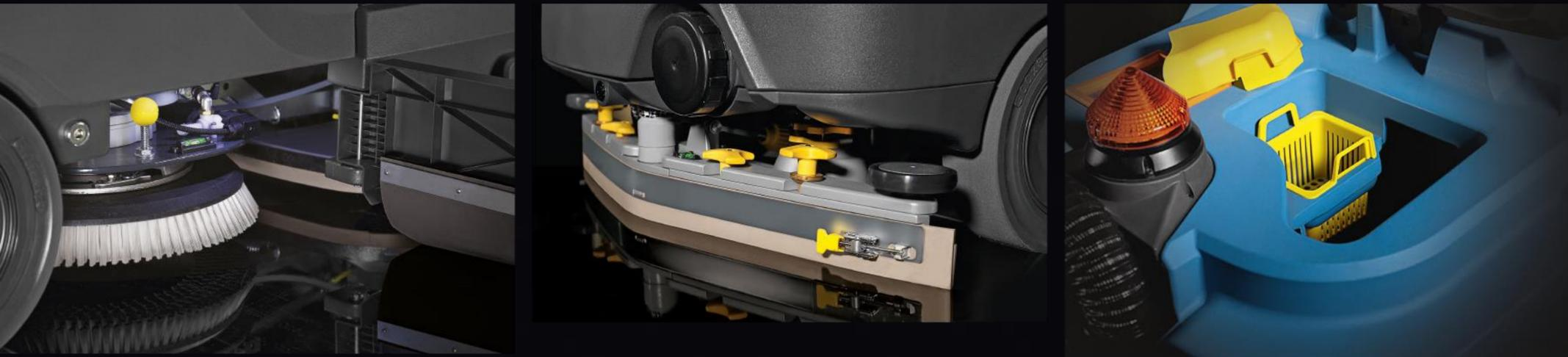
Die Teile, die am Ende der Arbeitsschicht regelmäßig gereinigt werden müssen, sind gelb gekennzeichnet, um Zeit zu sparen und die Scheuersaugmaschine stets in optimalem Zustand zu erhalten
