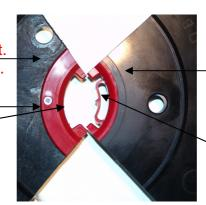
Die Original-Gansow-Bürste zeigt deutlich die Iunker- und porenfreie Oberfläche. Das Bajonett ist sauber eingeschweißt. Die Haltefeder ist gut zu erkennen.
