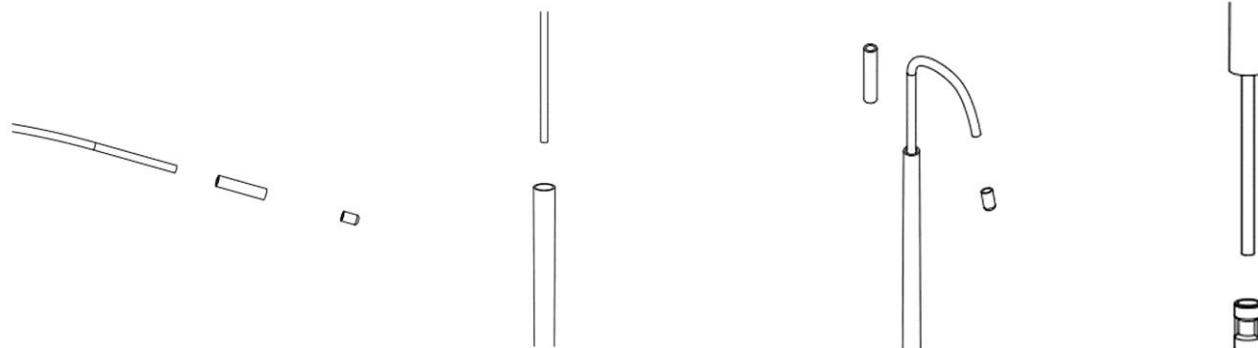
Entfernen Sie die Schutzkappe und den Markierungsschlauch an der biegbaren Spitze.
