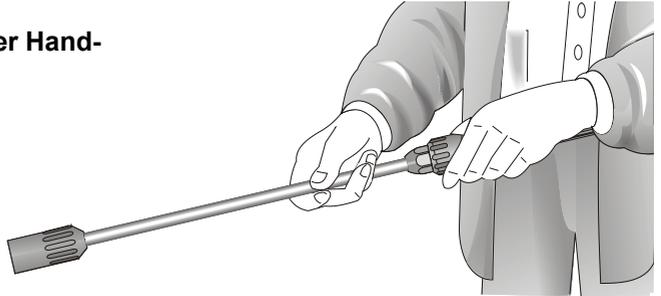
3. Hochdruckschlauch schlingenfrei abrollen und mit der Handpistole und Pumpe verbinden. Bei Verlängerung max. 20 m HD-Schlauch verwenden oder 2x 10 m mit Schlauchverbindungen.
