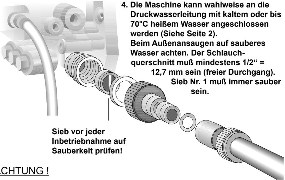
4. Die Maschine kann wahlweise an die Druckwasserleitung mit kaltem oder bis 70°C heißem Wasser angeschlossen werden (Siehe Seite 2).
