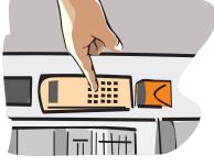
Geben Sie 1 Suma Café AutoTab in die Brüheinheit. Führen Sie das Reinigungsskript des Maschinenherstellers durch, um das Gerät zu reinigen und zu spülen. Leeren Sie nach Ende des Reinigungsprogramms den Abfallbehälter. Reinigen und trocknen Sie ihn und setzen Sie ihn wieder ein.
