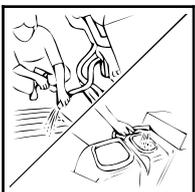
5. Ist die Reinigungslösung aufgebraucht, entleeren Sie den Schmutzwassertank und spülen ihn aus. Füllen Sie Wasser in den Sauberwassertank und ergänzen Sie das Reinigungsprodukt gemäß Herstellerempfehlung.
