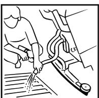
6. Nach Beendigung der Arbeit den Schmutzwassertank leeren und ausspülen. Spülen Sie auch den Sauberwassertank und die Bürsten/ den Führungsteller mit Pad. Reinigen Sie die Maschine mit einem feuchten Tuch.
