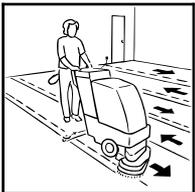
3. Kabelmaschinen: Arbeiten Sie in sich überlappenden Bahnen weg von der Steckdose. Scheuern Sie die zu reinigende Fläche und saugen Sie die Schmutzflotte direkt ab.
