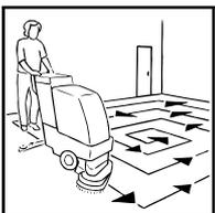
4. Batteriemaschinen: Arbeiten Sie in sich überlappenden Bahnen gegen den Uhrzeigersinn. Scheuern Sie die zu reinigenden Flächen und saugen Sie die Schmutzflotte direkt ab.
