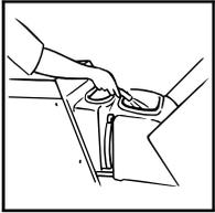
1. Entfernen Sie den losen Schmutz. Überprüfen Sie den technischen Zustand der Maschine. Füllen Sie Wasser in den Sauberwassertank und ergänzen Sie das Reinigungsprodukt gemäß Herstellerempfehlung. Montieren Sie den Führungsteller mit Pad oder eine Scheuerbürste.
