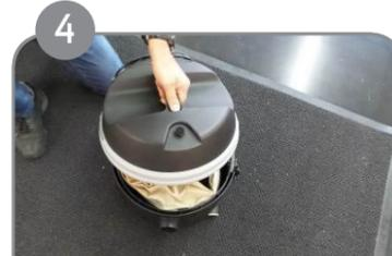
Entfernen Sie den Staubsaugerdeckel.
