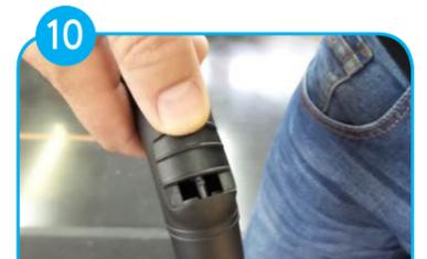
Der Luftzug kann geregelt werden indem die Saugkraft verstärkt oder vermindert wird.
