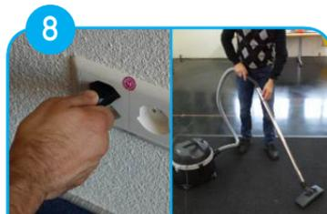
Verbinden Sie das Gerät mit dem Stromkreis und halten Sie das Kabel auf dem Boden, nicht gestrafft.
