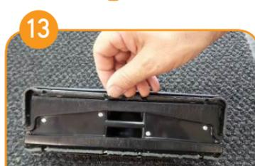
Entfernen Sie Staub und Schmutz von der Bodendüse. Überprüfen Sie den Schlauch auf Verstopfungen.
