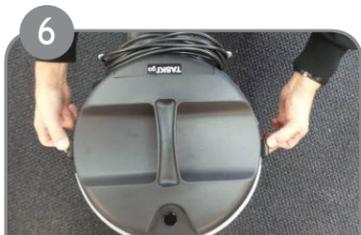
Setzen Sie den Deckel auf und verriegeln Sie diesen beidseitig.
