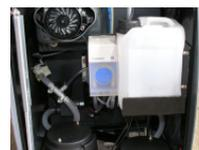
Das vom **GWS®** geregelte Frischwasservolumen aus dem Tank der Maschine, wird via **Durchflussmesser**, dieser regelt die Dosierpumpe, zu den Bürsten geführt. Die Reinigungschemie wird erst unmittelbar vor den Bürsten in den Volumenstrom des Frischwassers zudosiert.
