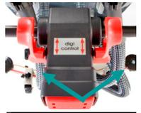
Die **Gansow-ACX-Steuerung** verarbeitet die Eingangsdaten der Voreinstellung Min - Max. und die des Fahrschalters zu einer variablen Ausgangsspannung für die Wasserpumpe.
