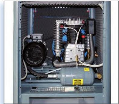
Innenansicht: Hochbelastbares Industriemotoraggregat mit 3 Liter Vordruckbehälter in kompakter Bauweise
