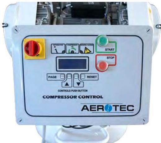
Bei mehreren Aggregaten wird dem Endanwender eine Ausfallsicherheit garantiert. Die Steuerung speichert die Gesamtarbeitszeit des Kompressors und die Arbeitszeiten jeder einzelnen Pumpeneinheit.
