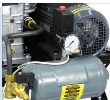
Komplett montiert mit Druckschalter und Zwischenkessel
