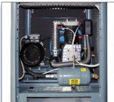
Innenansicht: Hochbelastbares Industriearrangement mit 3 Liter Vordruckbehälter in kompakter Bauweise
