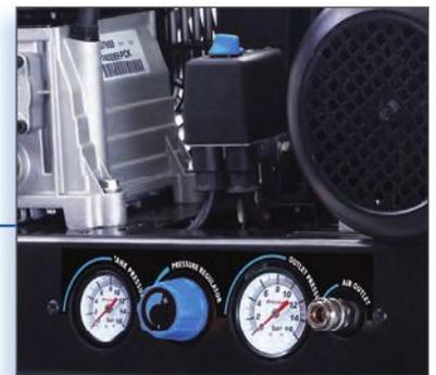
Manometer und Druckregler sicher in der Kesselkonsole verstaут. Mit extra großem Druckregler und 63 mm Manometern
