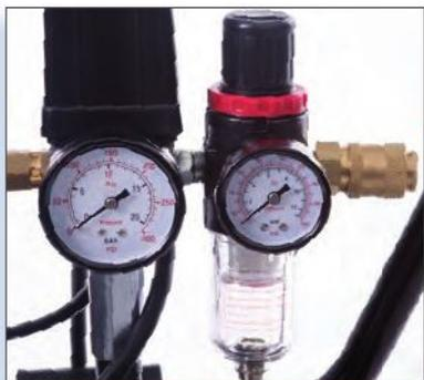
Filterdruckregler mit einer Filterfähigkeit von 20 Mikron zur Kondensatabscheidung am Druckluftausgang
