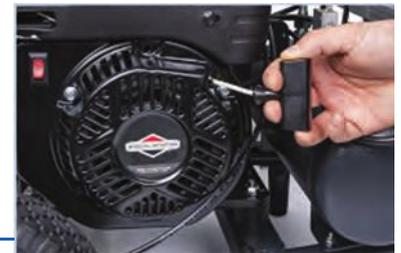
Benzin Briggs&Stratton- 4 Takt Motor mit Seilzugstarter
