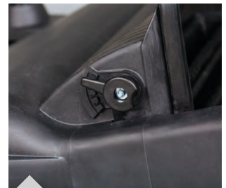
Einfache und werkzeuglose Höhenverstellung der Kehrwalzen
