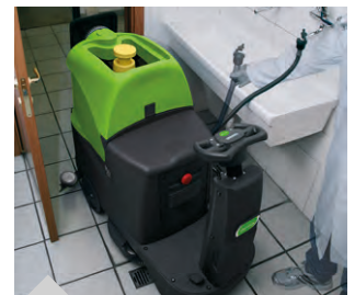
Frischwassertank mit Schlauch für Schnellbefüllung
