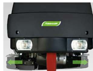
Reinigungsbürsten mit automatischem Einzug bei Stößen
