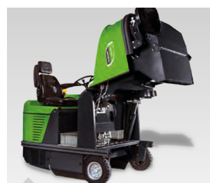
Hydraulische Entleerung des Kehrgutbehälters bis auf eine Höhe von 1,5 m
