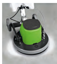
► Aufarbeiten und Schleifen von Estrichböden
