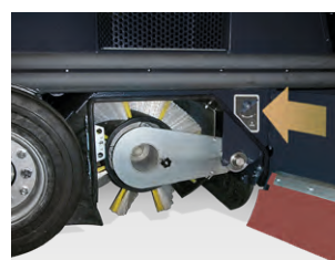
Hauptkehrwalze werkzeuglos austauschbar. Druck und Höheneinstellung der Hauptkehrwalze sind voneinander unabhängig einstellbar
