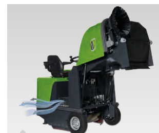
Hydraulische Entleerung des Kehrgutbehälters bis auf eine Höhe von 1,4 m.
