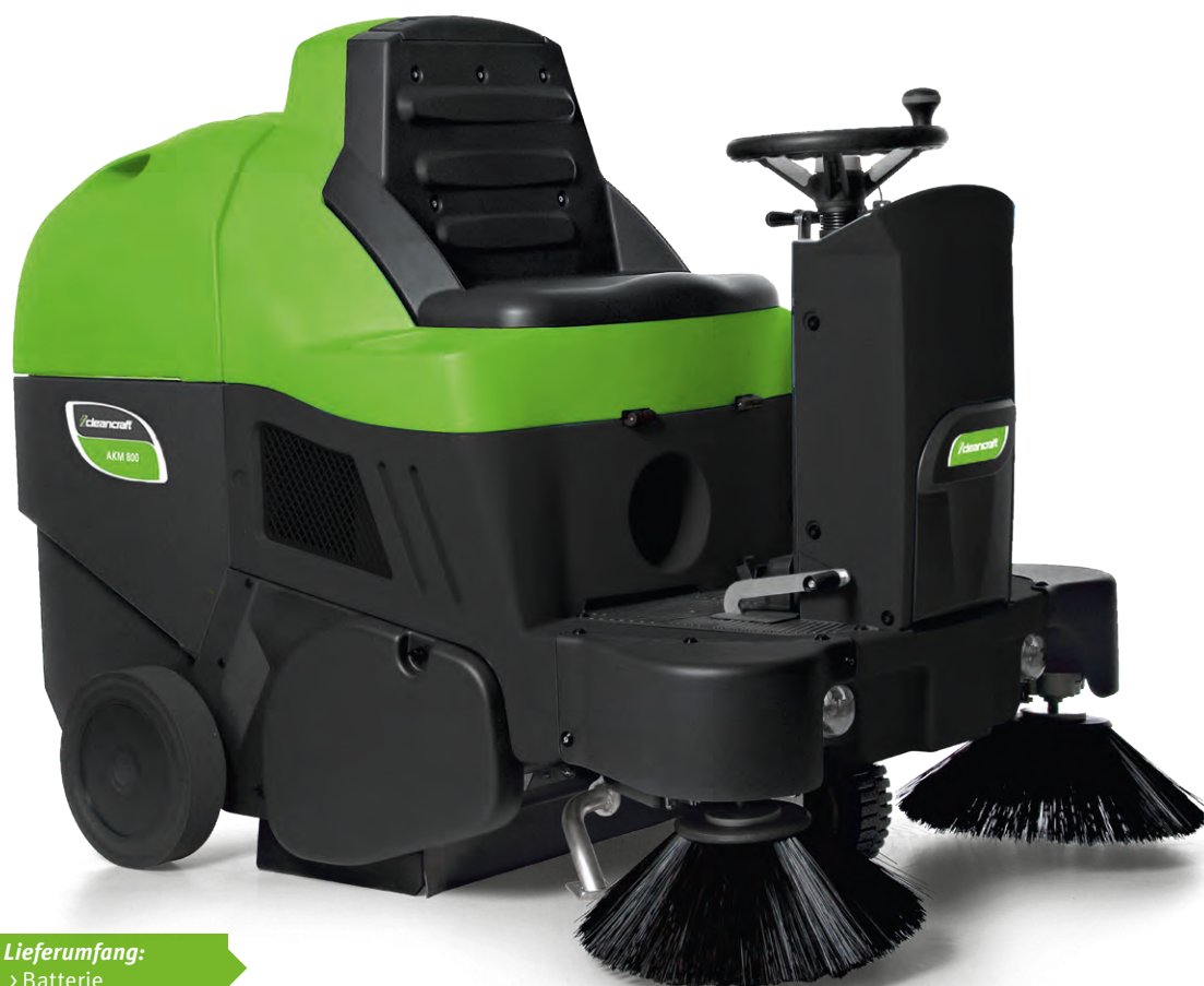
Mittel- und Seitenbürsten werkzeuglos austauschbar
