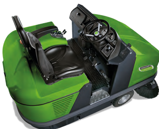
Hauptkehrwalze werkzeuglos austauschbar. Druck und Höheneinstellung der Hauptkehrwalze sind voneinander unabhängig einstellbar
