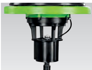
Automatische Filterabrüttelung beim Ausschalten des angeschlossenen Elektrowerkzeugs und manuelle Abrüttelung über Schalter
