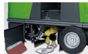
Hauptkehrwalze und Seitenbürste werkzeuglos austauschbar
