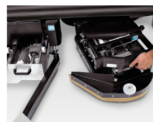
Der Grobschmutz wird von der Zylinderbürste in einen dafür vorgesehenen geräumigen Behälter gesammelt. Die Wartung der Bürsten ist dank ihrer leichten Austauschbarkeit sehr einfach
