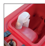
Effizienter Motorschutz dank Schwimmersystem
