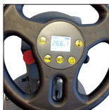
Lenkrad mit integriertem Display
