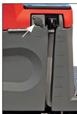
Einfüllöffnung (Schlauch) und Skala für Frischwassertank
