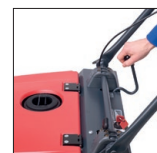
Hebel Seitenbesen absenken / anheben
