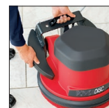
Für Transport Standardgewicht einfach wegnehmen
