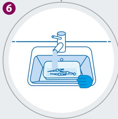
6 Abspülen der Instrumente unter fließendem Wasser für mind. 20 Sekunden.
