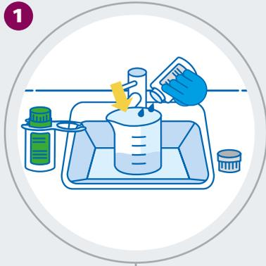
1 Einfüllen der oxidativen Komponente (Nr. 1, weißer Deckel). Flasche vollständig entleeren.
