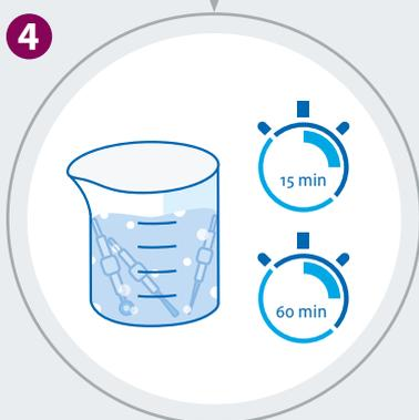
4 Reinigung beginnt mit Einfüllen der alkalischen Komponente. Angesetzte Reinigungslösung darf max. 60 Minuten verwendet werden. Innerhalb der 60 Minuten ist die Reinigungslösung wiederverwendbar, danach ist eine effektive Reinigungsleistung nicht mehr gegeben.
