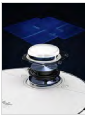
Lasernavigationssystem mit Kartierungsfunktion
