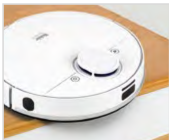
Hindernis- und Treppenerkennung mit 27 hochempfindlichen Infrarotsensoren
