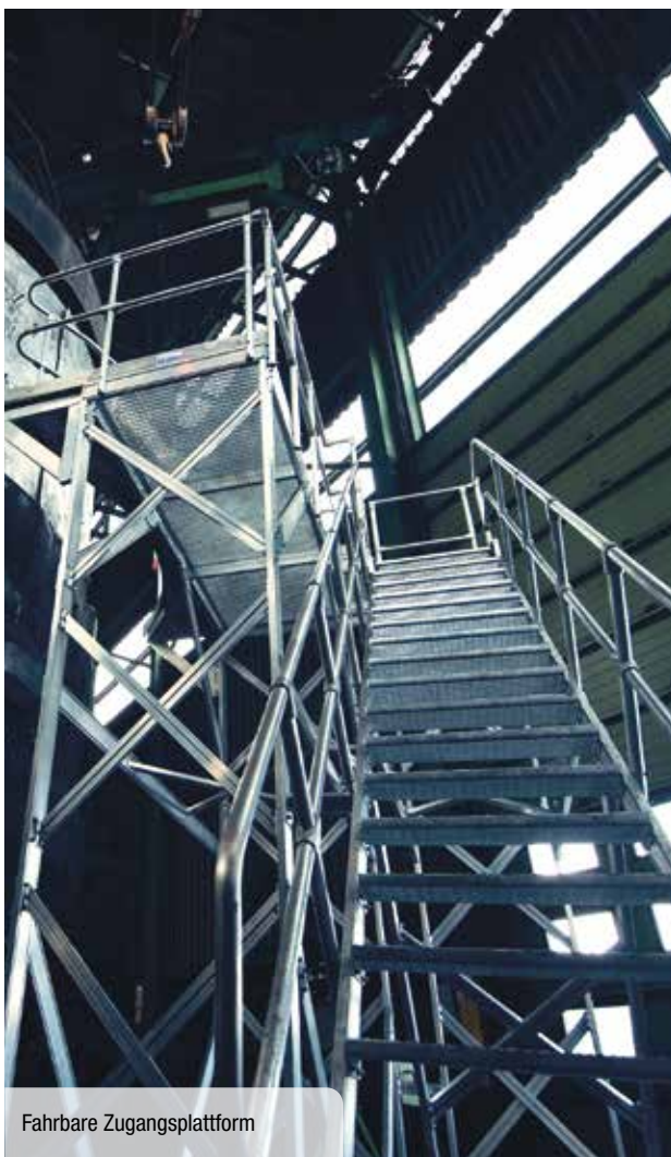
Fahrbare Arbeitsbühnen mit pulverbeschichteten Geländern
