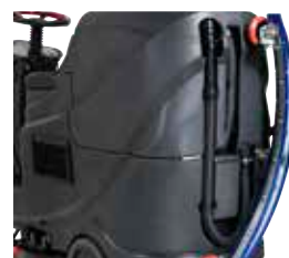
Platzsparende Aufbewahrung der Saugleiste. Somit ist ein Durchfahren enger Wege möglich.
