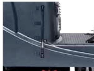
Gut sichtbare Anzeige für den Frischwasser-Füllstand.
