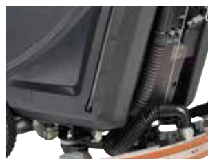
Übersichtliche Füllstandsanzeige am Frischwassertank.
