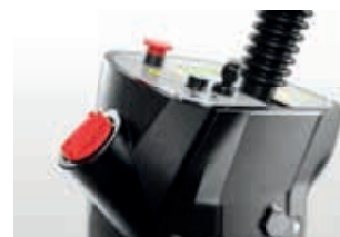
Unterbinden Sie wirkungsvoll die Ausbreitung von Staub: Entfernen Sie den roten Deckel und füllen Sie frisches Wasser in den Behälter zur Vernebelung über den Seitenbesen.
