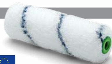
**Lösemittelbeständig.** Polyamid thermofusioniert. Für Beschichtungen, Grundierungen, Versiegelungen, Flüssigkunststoffe, Epoxyd- und Polyesterharze. Minimaler Faserabrieb, kein Verfilzen. Steckbügel-System 6 mm.
