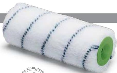
**Lösemittelbeständig.** Polyamid thermofusioniert. Für Beschichtungen, Grundierungen, Versiegelungen, Flüssigkunststoffe, Epoxyd- und Polyesterharze. Minimaler Faserabrieb, kein Verfilzen. Steckbügel-System 8 mm.
