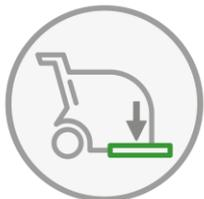
Der Empfohlene Mindestdruck für eine Einscheibenmaschine, Aufsitzer und Scheuersaugautomaten liegt bei ca. 40 kg. Die optimale Reinigungsumdrehung liegt bei 150-190 U/min bei einer Reinigungsgeschwindigkeit von 3-5 km/h.
