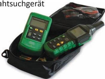
Geprüft werden können Kabel & Leitungen in Wand, Boden, Erde usw. Die Reichweite beträgt bis zu zwei Meter, die Sensibilität ist einstellbar. Das Gerät ist ein Set aus Sender und Empfänger. Zum Betrieb beider Geräte benötigt man 1 x 9 V Block Batterie sowie 6 x 1,5 V Batterie Form AAA. Weitere Informationen [www.rumsauer.eu](http://www.rumsauer.eu). Video unter [www.youtube.com/VORTbroadcast](http://www.youtube.com/VORTbroadcast)
