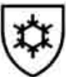
Schutzhandschuhe die vor konvektiver Kälte (thermische Isolation) und/oder vor Kontaktkälte (thermischer Widerstand) schützen. Grad und Umfang des Schutzes werden mit drei Leistungsstufen gekennzeichnet. Dabei reichen die möglichen Leistungsstufen bei konvektiver Kälte und Kontaktkälte von 1-4. Die Wasserdichtheit wird durch zwei Leistungsstufen gekennzeichnet. 0 = durchlässig nach 30 min, 1 = durchlässig nach mehr als 30 min.
