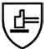
Schutzhandschuhe gegen mechanische Risiken sind mit einem entsprechenden Piktogramm gekennzeichnet, gefolgt von vier Zahlen (Leistungsstufen, welche die Prüfergebnisse gegen mechanische Risiken repräsentieren).
