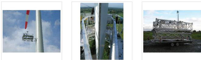
Die Rotorblattbefahranlage UVM10L wird als Rotorblatt-Überfahrssystem für die temporäre Inspektion der Rotorblätter von Windkraftanlagen eingesetzt, die auf runden Stahl- oder Betontürmen montiert sind. Die UVM10L ist eine einfach zu installierende Lösung, um die meisten der installierten Rotorblätter von etwa 2 MW-Turbinen zu erreichen. Das Bewegungssystem besteht aus drei Hauptfunktionen und besteht hauptsächlich aus geschweißtem Aluminium.
